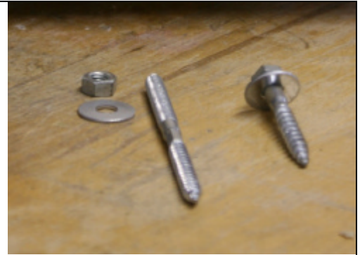
Links Stockschraube - Rechts Gestellschraube
